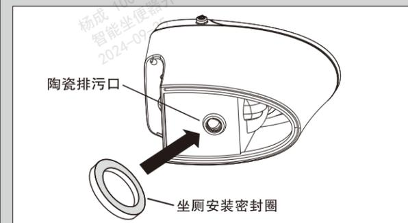
4. 两个人将陶瓷抬起，以地面排污口十字标记为对照，将陶瓷体上的记号对准地面十字标记，慢慢将陶瓷放在地面上，使两者标记重合。在重合后，将陶瓷体向下按压，使油泥充分接触地面，与地面连接紧密。
